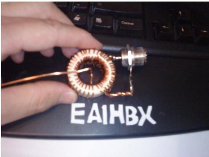
**En el secundario**,y soldando **desde el lado de masa** únicamente en el mismo sentido del primario,bobinas entre 27-30 vueltas entrelazadas,dependiendo de la altura de la caña.Puedes ir probando para la banda que más se adecue.
