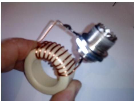
Aquí tenemos un ejemplo de cómo empezar a bobinar el primario con el cable con 9 vueltas. Le hemos soldado el conector en sus extremos.
